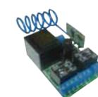
Блок дистанционного управления CV01 имеет встроенный приемник для пультов DoorHan. Возможно подключение внешних приемников большинства производителей воротной и роллетной автоматики.
